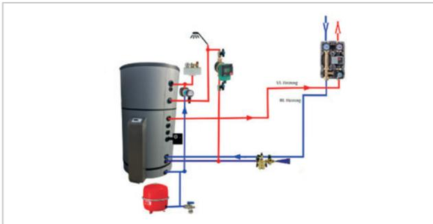
AWE nutzt mit dem Direktkondensationsspeichersystem die hohen Heißgastemperaturen des Verdichters und entheizt das Kältemittel im oberen Teil des Speichers. Im unteren Bereich des Speichers wird das Kältemittel verflüssigt.
